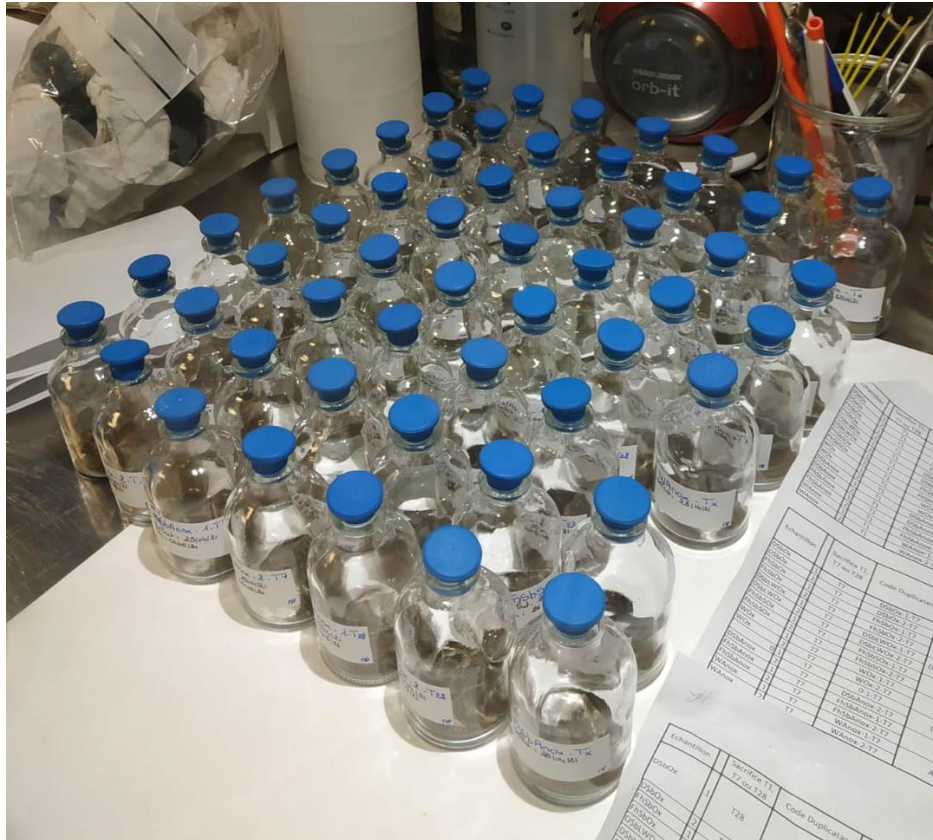
Figure II.38 : Schéma global des incubations mises en places pour cette étude (en haut) et photographie de la préparation des incubations après ajout du sédiment en attente d'ajout d'eau avant la sortie de BAG (en bas)
