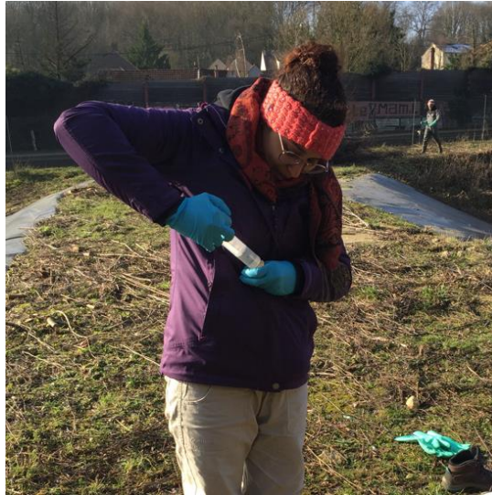
Figure II.21 : Filtration des échantillons d'eau sur site (Orsay) à l'aide d'une seringue de 50 mL et de filtres PES 0,22 \mu m
