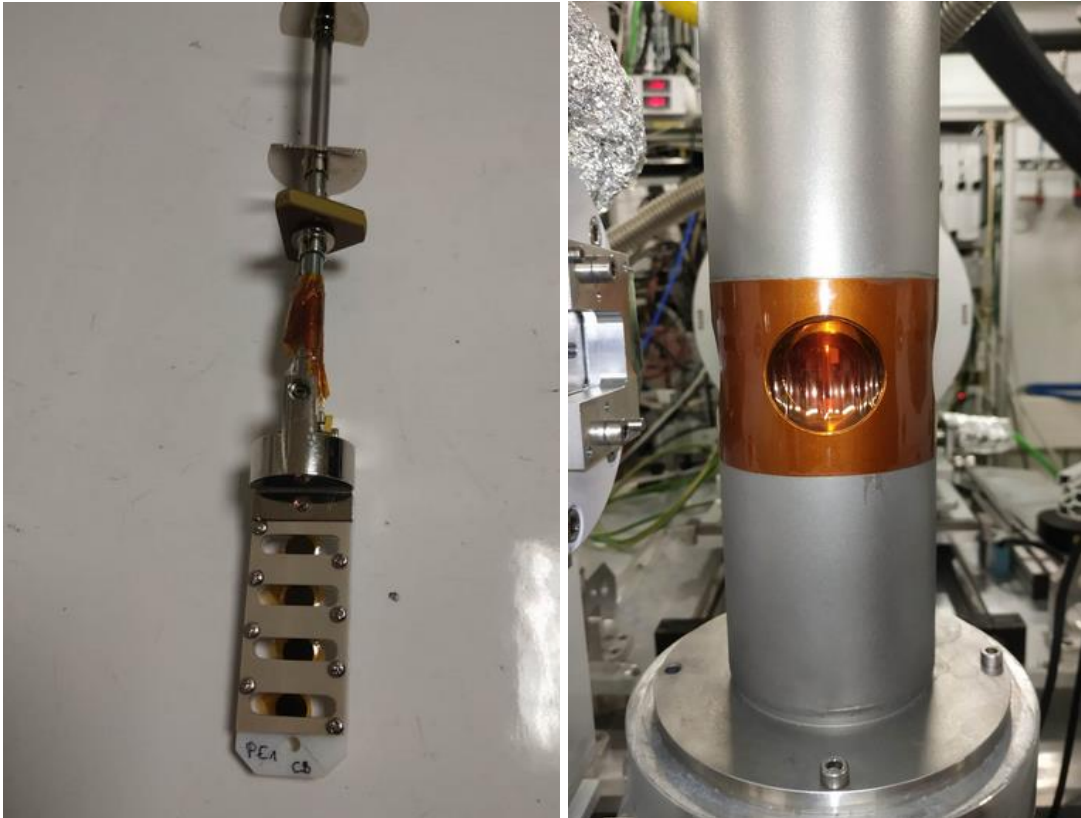
Figure II.30 : À gauche, pastilles kaptonnées montées sur porte échantillon et vissé à la canne qui sera plongée dans le cryostat représenté sur l'image de droite
