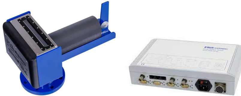
FIGURE 2.6 – Tête (à gauche) et interface (à droite) du sondeur multifaisceaux de la marque R2Sonic version 2022. La tête est composée d'une antenne de réception rectangulaire (à gauche) et d'une antenne d'émission cylindrique (à droite). Le module d'interface sert à la création des impulsions et aux réglages des paramètres. (Source : R2Sonic)
