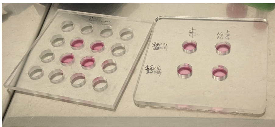
Figure 2.20 – Puits de culture contenant du milieu de culture au fond duquel les cellules se trouvent. La mise en puits des cellules est réalisée pour les deux types de plaques.
