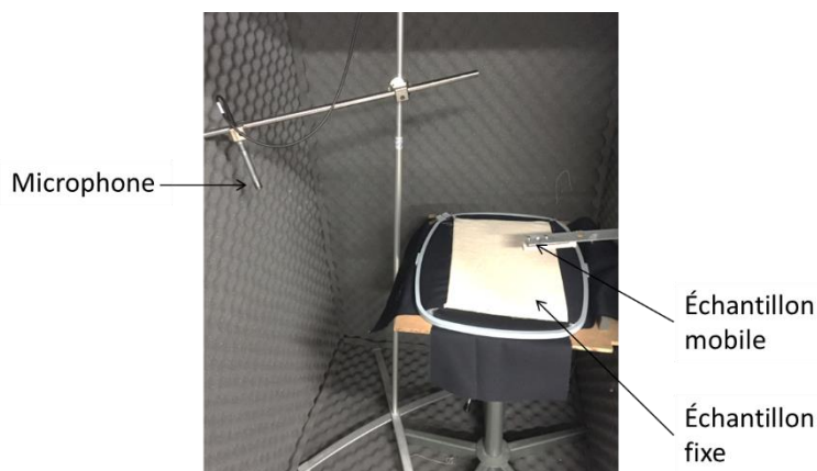
Figure 37 : Placement des porte-échantillons [3]
