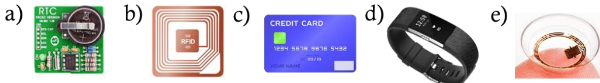
Figure 1-2. Exemples de systèmes électroniques utilisant des microbatteries : a) horloge à temps réel alimentée par une pile bouton, qui pourrait être remplacée par une microbatterie, b) radio-étiquette, c) carte bancaire intelligente, d) montre bracelet digitale et
