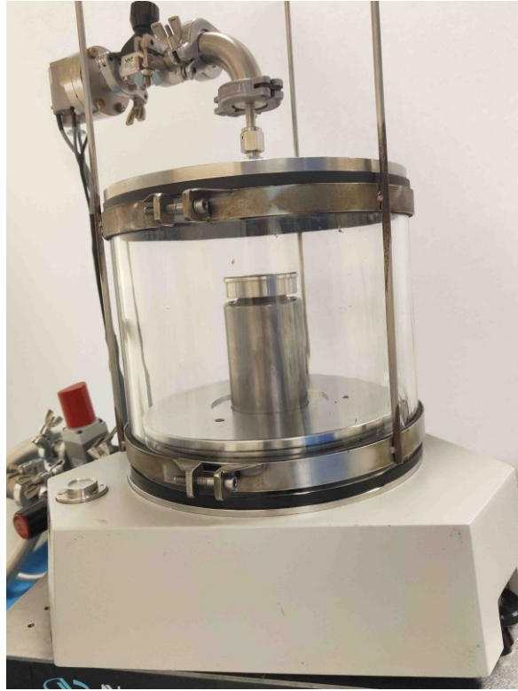
Figure 3.10. Balance de pression à piston tournant PG7607.
