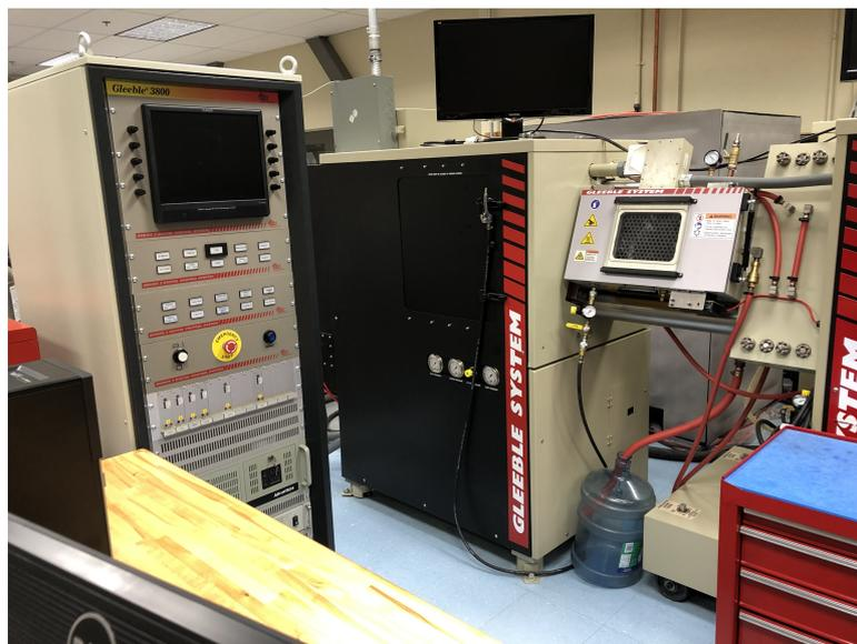
FIGURE 1.12 – Simulateur thermomécanique Gleeble-3800 – ÉTS CM2SP, Montréal.
