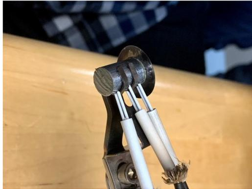
FIGURE 5.1 – Utilisation de trois thermocouples fixés sur un échantillon.
