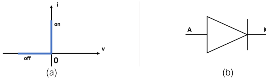
Figure I.5 - Diode : (a) caractéristique I-V idéalisée (b) symbole électrique
