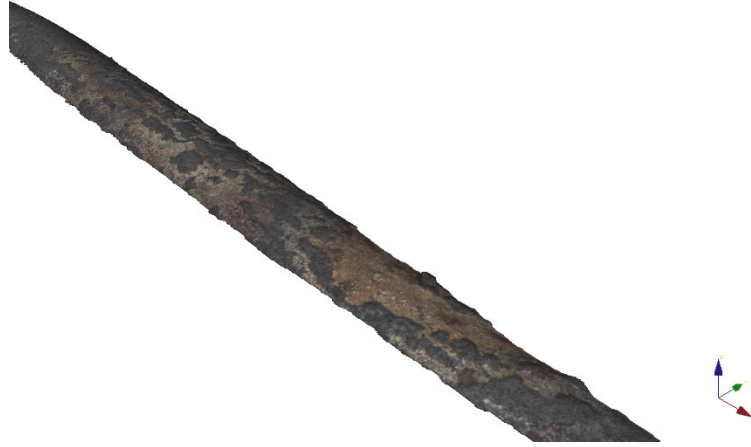
Figure 14 : L'oxydation du fil après recuit.
