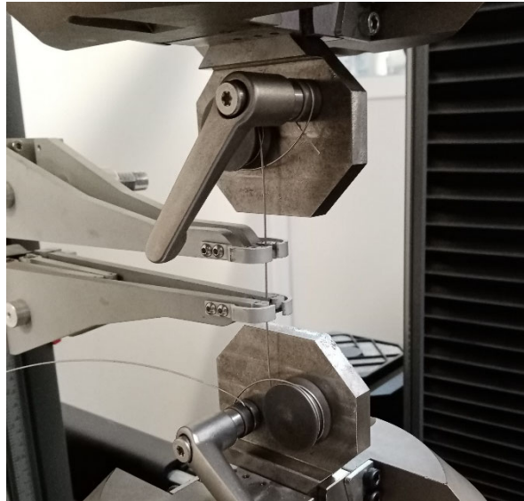
Figure 2-7 : Le montage du fil sur des pinces à cabestan.
