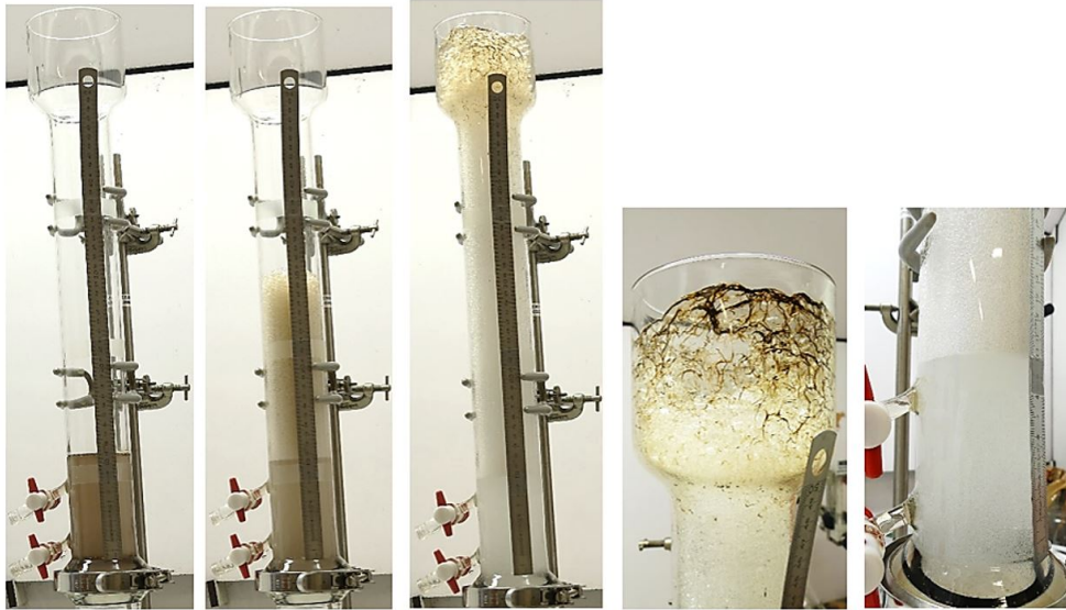
FIGURE A.6 – Formation de mousse dans la colonne de flottation : BSA 50 mg/L
