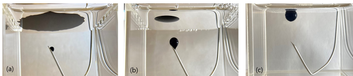
FIGURE 4.11 – Étalement d'une goutte à la surface eau-air (coalescence goutte-bulle) : (a) BSA, (b) Saponine et (c) HFBII.
