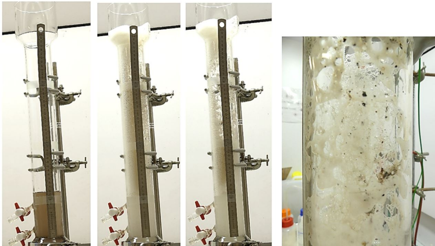
FIGURE A.3 – Formation de mousse dans la colonne de flottation : émulsion avec 100 \text{ mg/L} de Saponine
