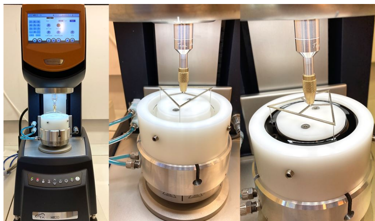
FIGURE 4.2 – Rhéomètre HR20 avec la géométrie DWR (Waters | TA Instruments)
