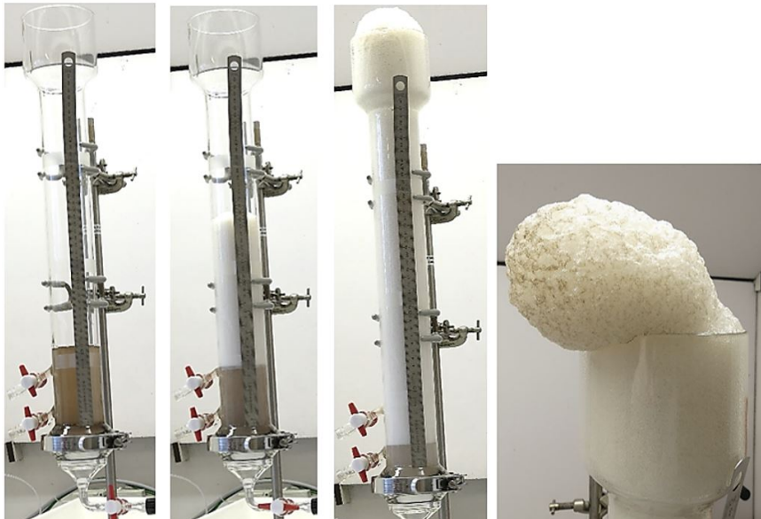
FIGURE A.7 – Formation de mousse dans la colonne de flottation : BSA 300 mg/L
