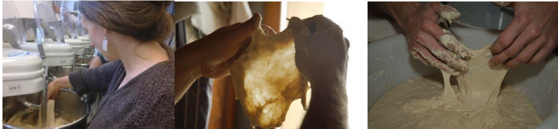
Figure 73. Mesure de l'extensibilité par étirement de la pâte (extension uniaxiale) et appréciation de l'extensibilité par la formation d'un film (extension biaxiale)
