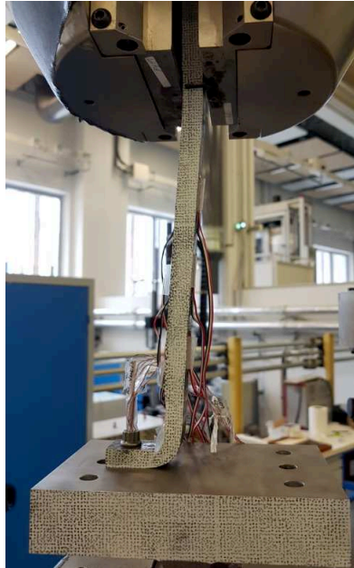
FIGURE 3.11 – Visualisation du mouchetis sur la tranche de la bride et du socle.
