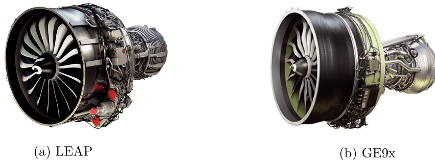
FIGURE 2 – Moteurs intégrant le CMO comme matériau de la ligne du carter, assemblée grâce à des liaisons boulonnées.
