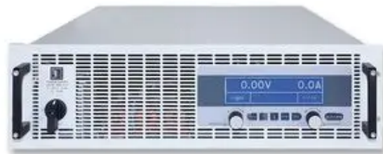
FIGURE 3.18 – Alimentation DC « Elektro- Automatik EA-PS 9750-20 » .
