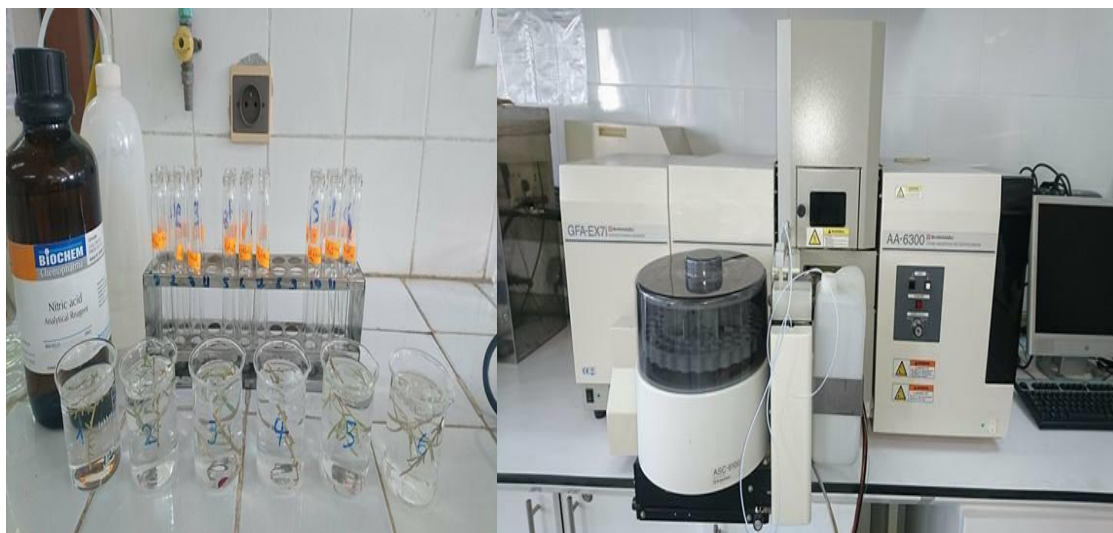
Figure II-8: Protocole expérimental de la détermination du cadmium excrétée à la surface de la feuille
