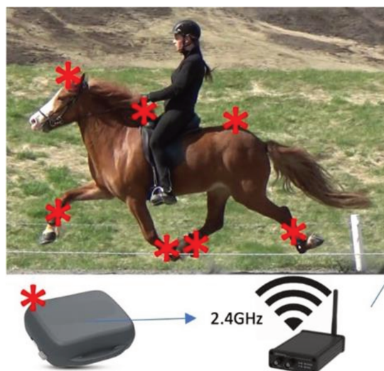
Figure 13 Le système EquiMoves monté (Serra Bragança et al., 2020)
