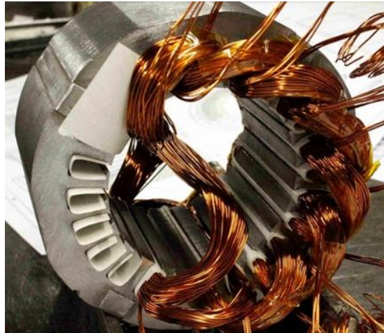
Figure VI-9 Bobinage en vrac en cours de réalisation selon les données de la Figure VI-1 et le Tableau VI-1.
