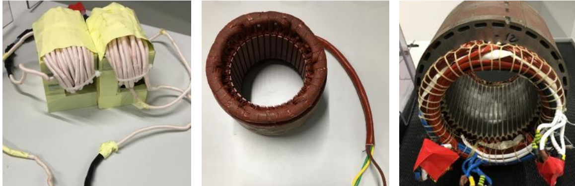
Figure V-4 charges utilisées dans la chaine bifilaire. (a) bobine-Litz, (b) stator 10kW et (c) stator 45kW.
