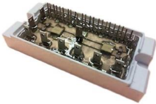
Figure V-51 Module CULPA développé à l'IRT Saint-Exupéry intégrant des capacités pour réduire l'inductance parasite des mailles de commutation.
