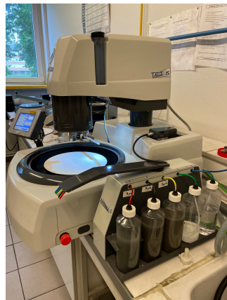
(a) Dispositif de polissage avec les solutions diamantée
