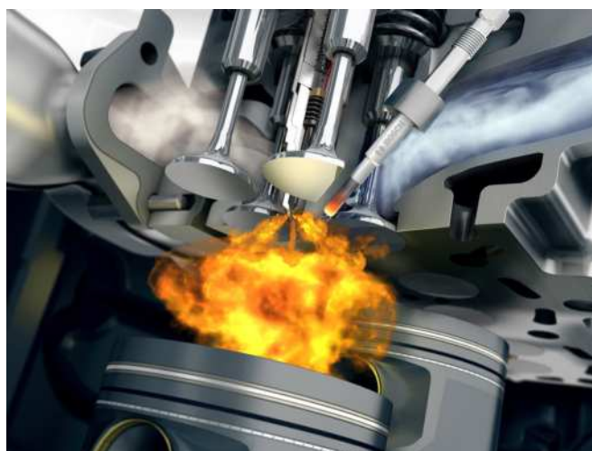
Figure C.2. Schéma d'un moteur Diesel à combustion
