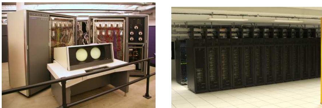
Figure C.3. A gauche le supercalculateur CDC 6600 avec sa console, lancé en 1964, et à droite le supercalculateur Occigen installé par GENCI au CINES, à Montpellier ; avec lesquelles les bases de données présentées dans cette thèse ont été obtenues.
