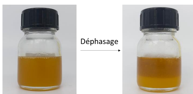
Figure 5-3 : Déphasage de l'échantillon d'huile de lin + PbO 50 %mol chauffé en présence d'eau.
