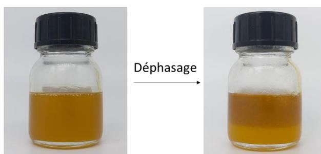
Figure 5-3 : Déphasage de l'échantillon d'huile de lin + PbO 50 %mol chauffé en présence d'eau.
