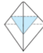
Fig. I.4 -b Visualisation de l'aire de contact projetée A_c d'un indenteur pyramidal [58].
