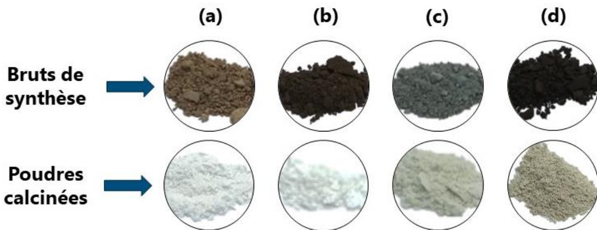
Figure III.2. Images des poudres série 1 avant et après calcination : TiO_2 -He (a), TiO_2 -Ar (b), : Cu/TiO_2 -He (c) et : Cu/TiO_2 -Ar (d).
