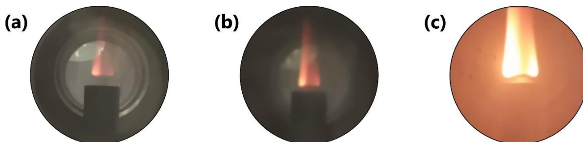
Figure IV.2. Images des flammes de pyrolyse laser obtenues pour les échantillons 4Cu/TiO_2 série 2 en conditions A (a), B (b) et 2 (c).
