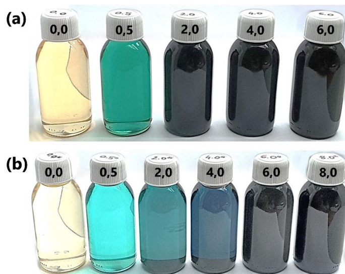
Figure IV.1. Photographies des précurseurs série 2 « purs » de 0 à 6 %m de Cu (a) et précurseurs « dilués » de 0 à 8 %m de Cu (b). Les chiffres indiqués correspondent aux pourcentages massiques de cuivre.
