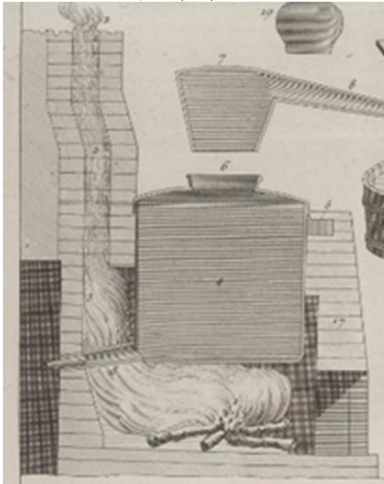
Illustration 19. Fourneau à bois et cucurbite, détail (1781).
