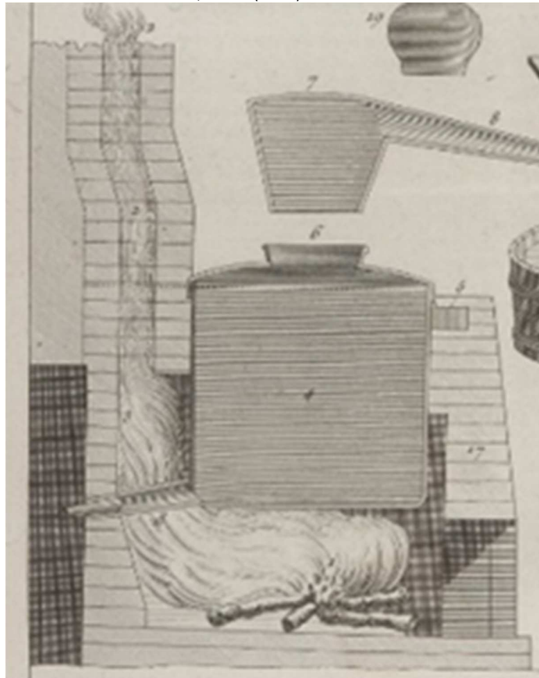
Illustration 19. Fourneau à bois et cucurbite, détail (1781).
