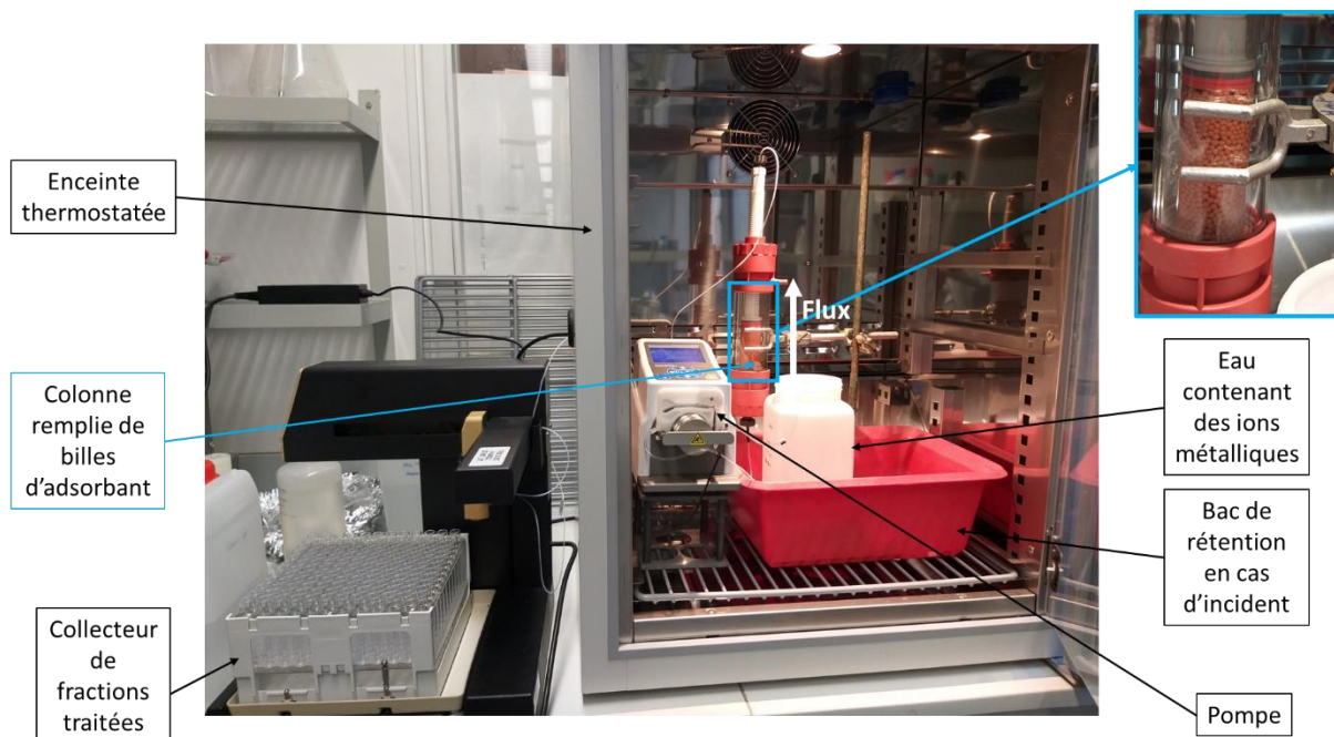
Figure 2.11 : Système d'adsorption en colonne
