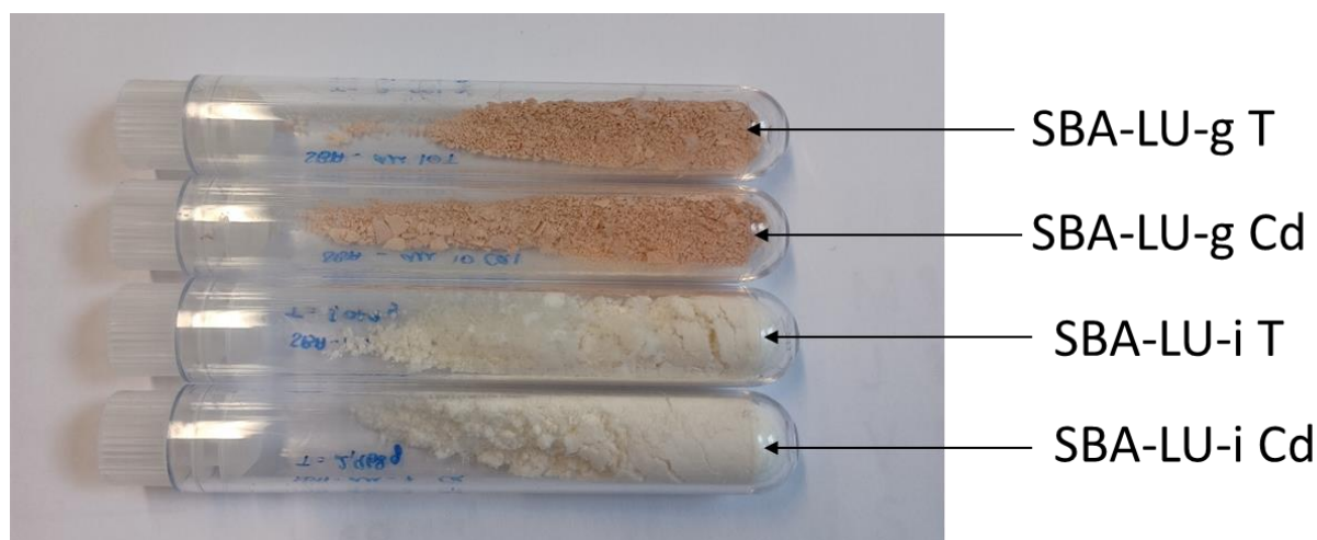
Figure 7.7 : Matériaux fonctionnalisés avec les extraits de cellules de lin témoin (T) ou traitées au cadmium (Cd) par greffage (SBA-LU-g) ou imprégnation (SBA-LU-i)
