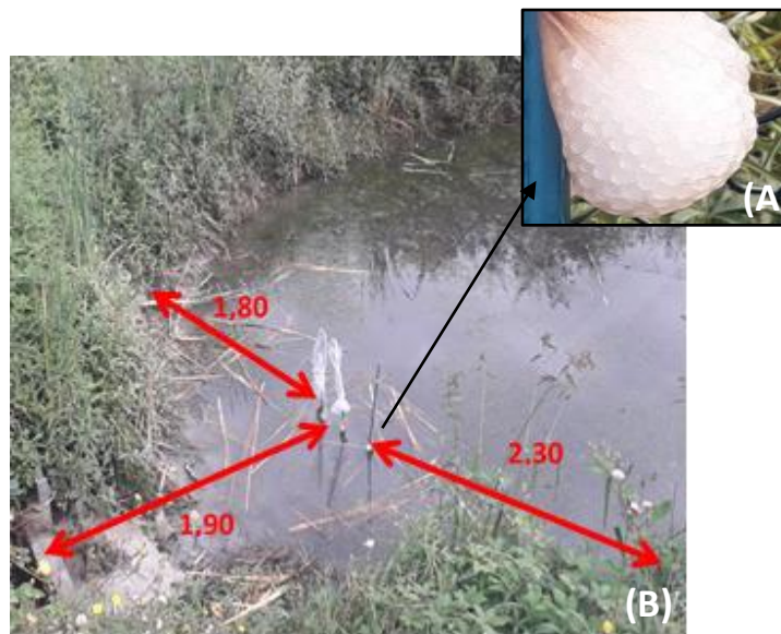
Figure 6.9 : Sachets de billes ALG 2% (A) déposés dans la mare du site expérimental de l'Ostwaldergraben (B)
