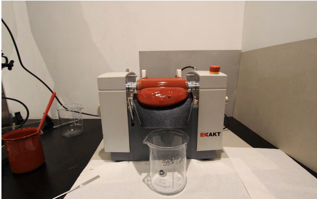
Figure 51 : Photo d'un essai de pâte pigmentaire avec une broyeuse.
