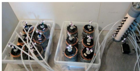
Dispositif de mesure du métabolisme et des pertes hydriques totales au repos en flux fermé
