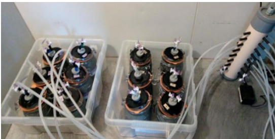
Dispositif de mesure du métabolisme et des pertes hydriques totales au repos en flux fermé
