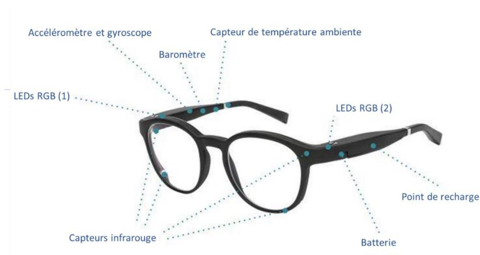
**Figure 19.** Capteurs intégrés dans la paire de lunettes connectées
