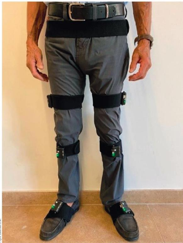
Figure 3. Placement des capteurs inertiels sur le bas du corps.
