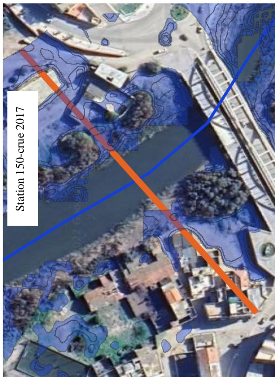
Figure V.16. Ligne d'eau observée (crue 2017) et simulée (période de retour centennale) à la station transversale 150.
