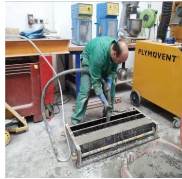
(b): Vibration des bétons de fibres
