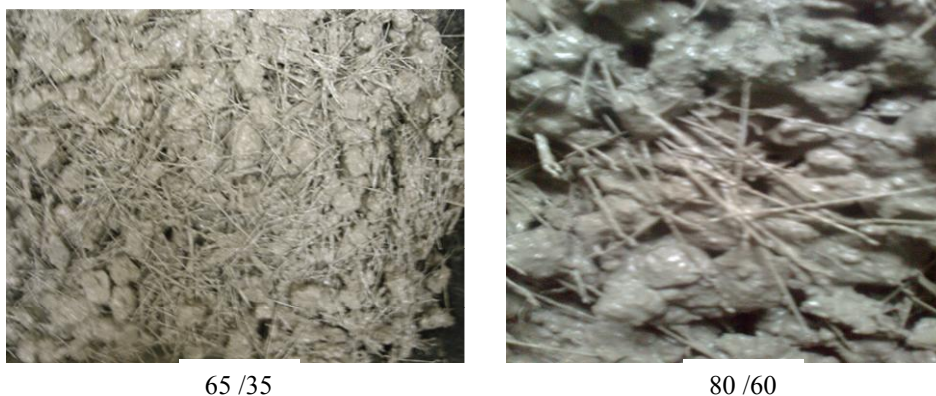
Figure 3.6: Distribution des fibres dans le béton frais
