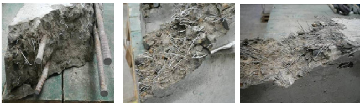
Figure 6.8: Distribution et déformation des fibres après rupture
