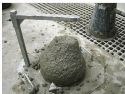
Figure 3.9: Mesure de l'affaissement du BHP
