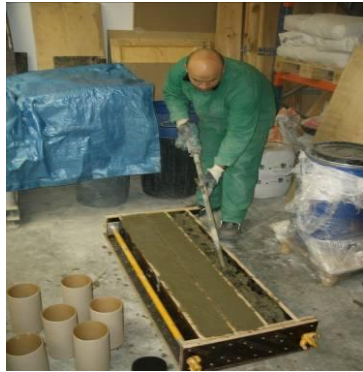
(a): Vibration des bétons sans fibres
