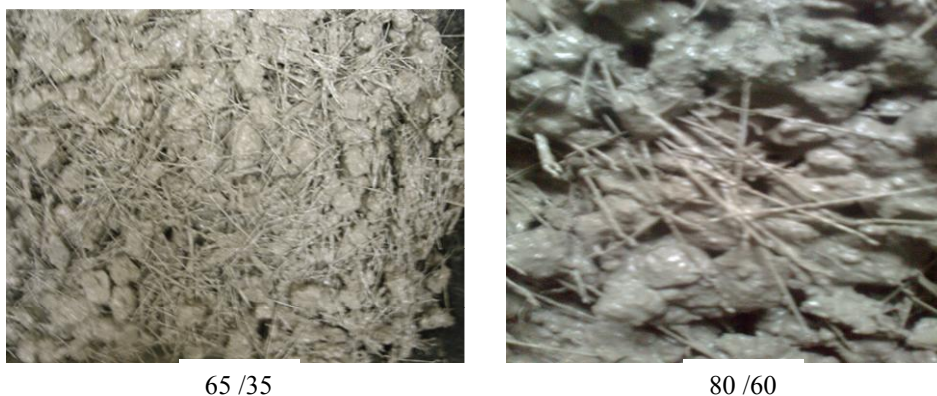
Figure 3.6: Distribution des fibres dans le béton frais
