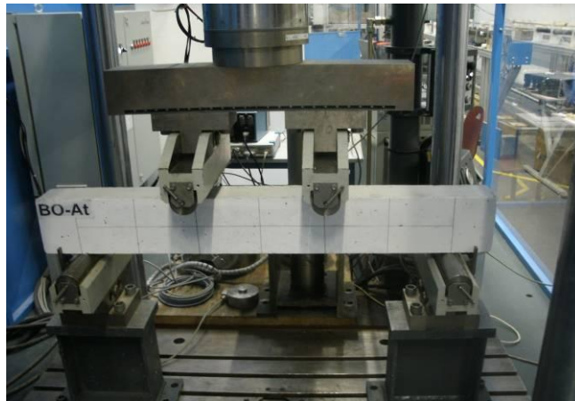
Figure 1.1 : Flexion quatre points
