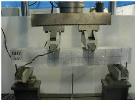
Figure 6.5 : Poutre sans fibres - rupture fragile et brutale par effort tranchant-
