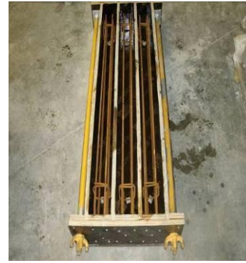
(b): Sans armatures transversales
