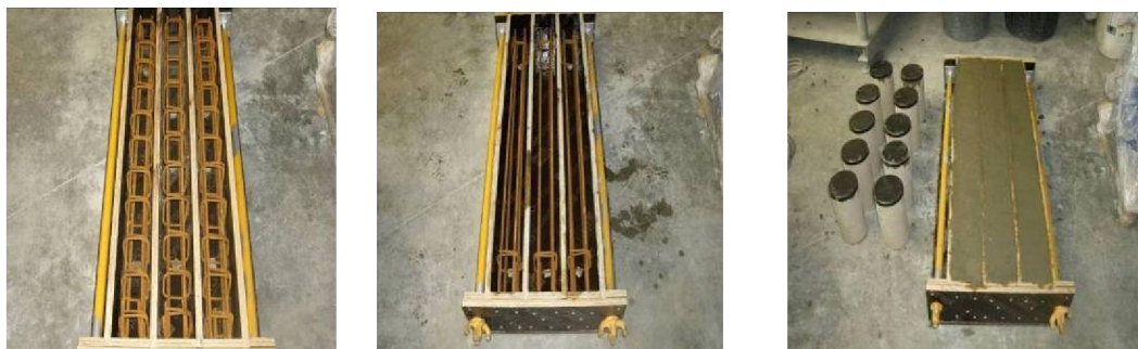
(a) poutres avec cadres (b) poutres sans cadres (c) coulage des poutres en BHP fibré
