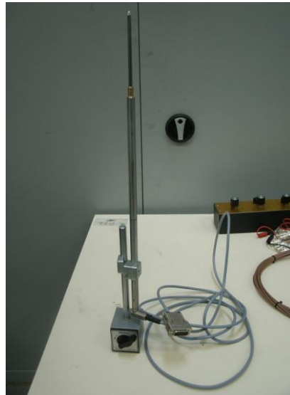
Figure 3.17 : Capteur de déplacement LVDT- WA100
