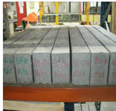
(d): Après décoffrage (béton durci)
