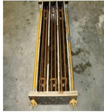
(b): Sans armatures transversales
