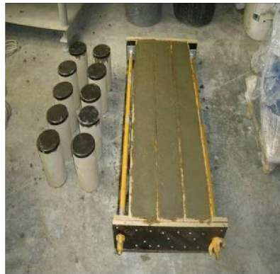
(c): Après coulage (béton frais)
