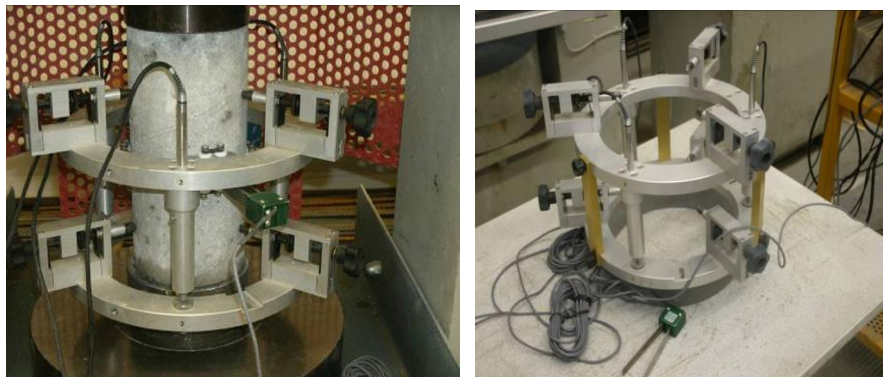
Figure 3.11: Essai de compression et dispositif utilisé
