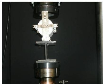
*Figure 3.12: Essai de traction par fendage*
