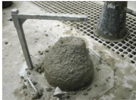
Figure 3.9: Mesure de l'affaissement du BHP
