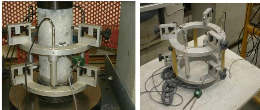
*Figure 3.11: Essai de compression et dispositif utilisé*
