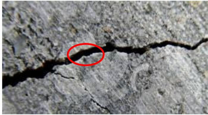
Figure 5.7 : La fissure traverse les granulats dans le BHP
