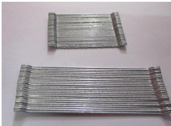
Figure 6.1: Fibres utilisées dans le mélange béton
