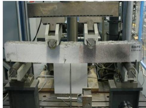
Figure 6.6 : poutre avec fibres
