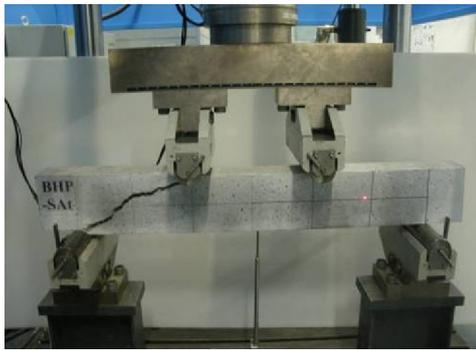
Figure 6.5 : Poutre sans fibres
