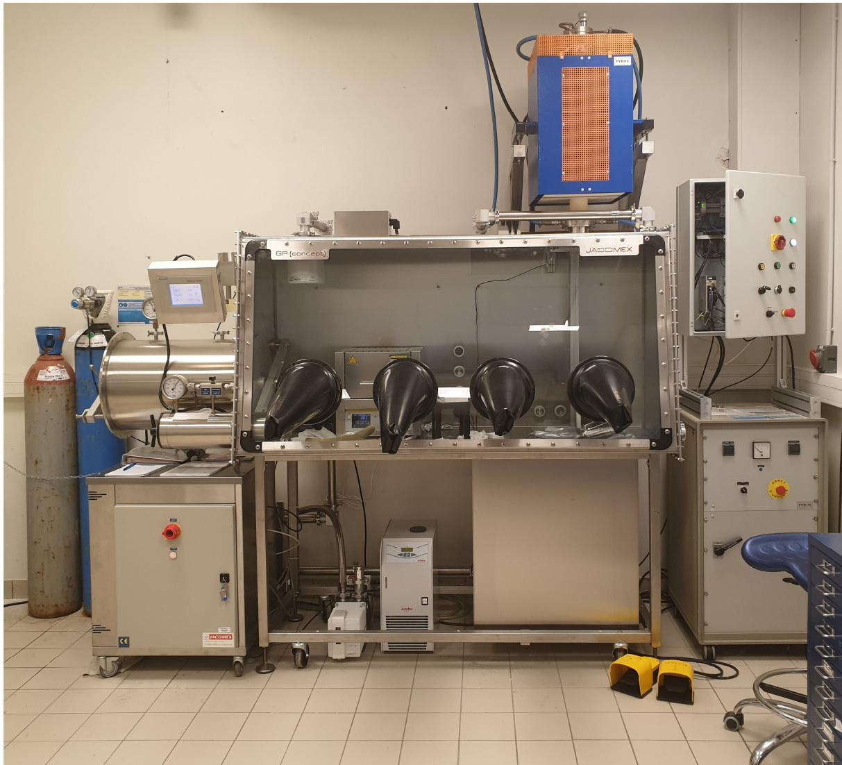
Figure II-6 : Photographie de l'enceinte de synthèse des verres oxyazotés.
