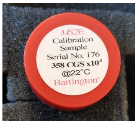
Photo 4. Echantillon de calibration du susceptibilimètre
