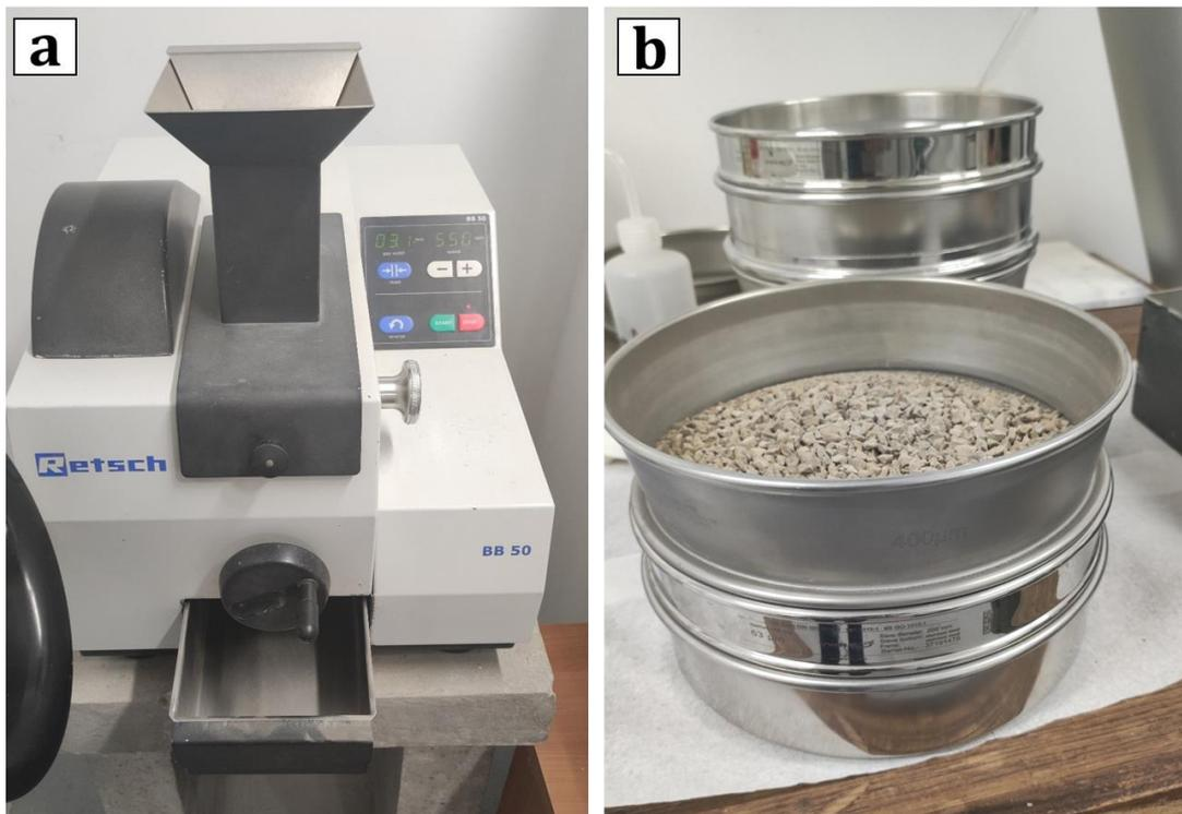
Figure 2.20: a) Broyeur à mâchoires est utilisé pour réduire les échantillons en petits morceaux au laboratoire Géosciences Paris-Saclay. b) Série de tamis métalliques utilisés pour séparer les fractions.
