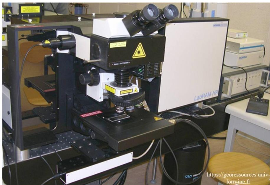
Figure 2.11: Microspectromètre Raman LabRAM (Horiba) du laboratoire GeoRessources de l'Université de Lorraine.
