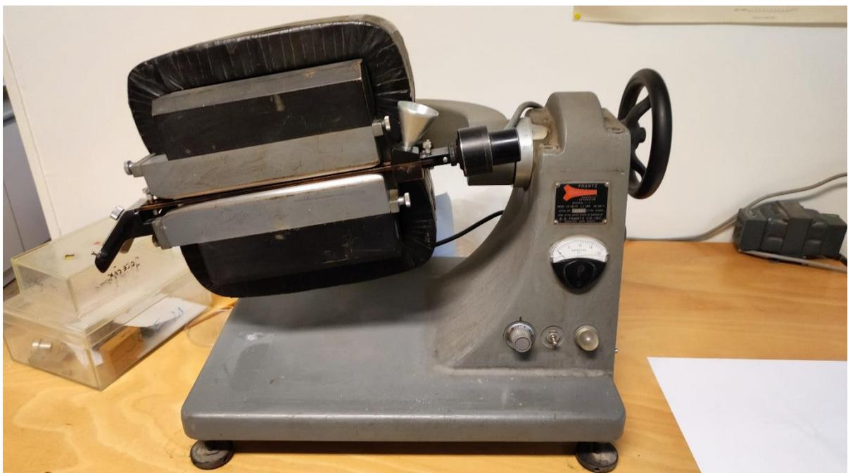
Figure 2.22: Photographie du séparateur à barrière de type Frantz® au laboratoire Géosciences Paris-Saclay.
