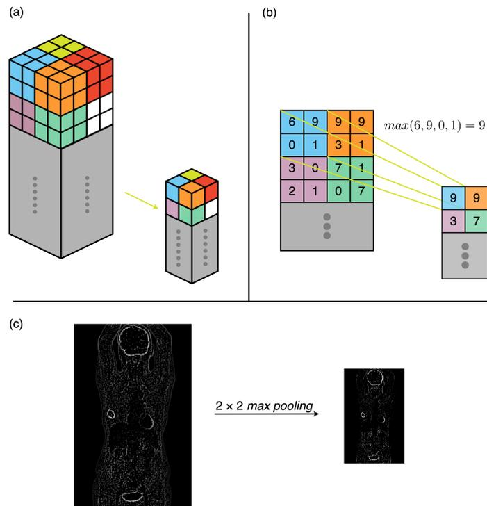
Figure 3.3 – (a) Illustration du *max pooling* en 3D. (b) Exemple d'application numérique en 2D. Dans le cas du *max pooling*, la valeur maximale des voxels superposés au filtre est conservée pour produire l'image en sortie. (c) Exemple d'application du *max pooling* à une carte de caractéristiques provenant de la projection d'intensité maximale (*maximum intensity projection* (MIP)) de l'image TEP d'une patiente atteinte de cancer du sein.
