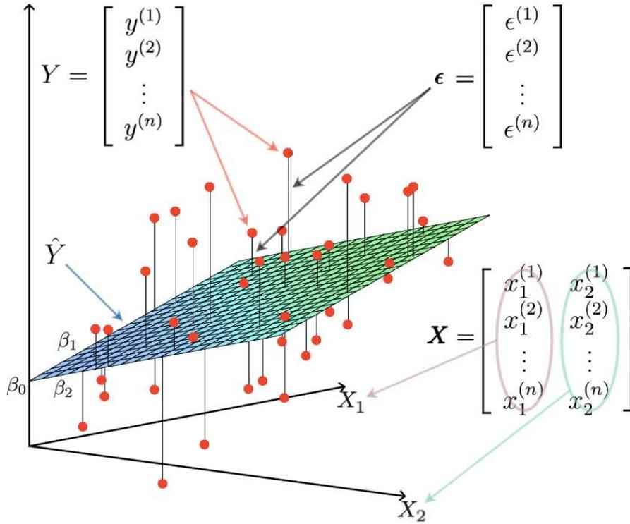
Figure 3.7 – Illustration d'une régression linéaire par moindres carrés avec  $\mathbf{X} \in \mathbb{R}^{n \times 2}$ .  $\hat{Y}$  dessine un hyperplan d'ordonnée à l'origine  $\beta_0$ , et de pentes  $\beta_1$  et  $\beta_2$  dans les directions respectives  $X_1$  et  $X_2$ . C'est la fonction linéaire de  $\mathbf{X}$  qui minimise la somme des résidus de  $\epsilon$  au carré. Figure adaptée de Hastie et al. [168].
