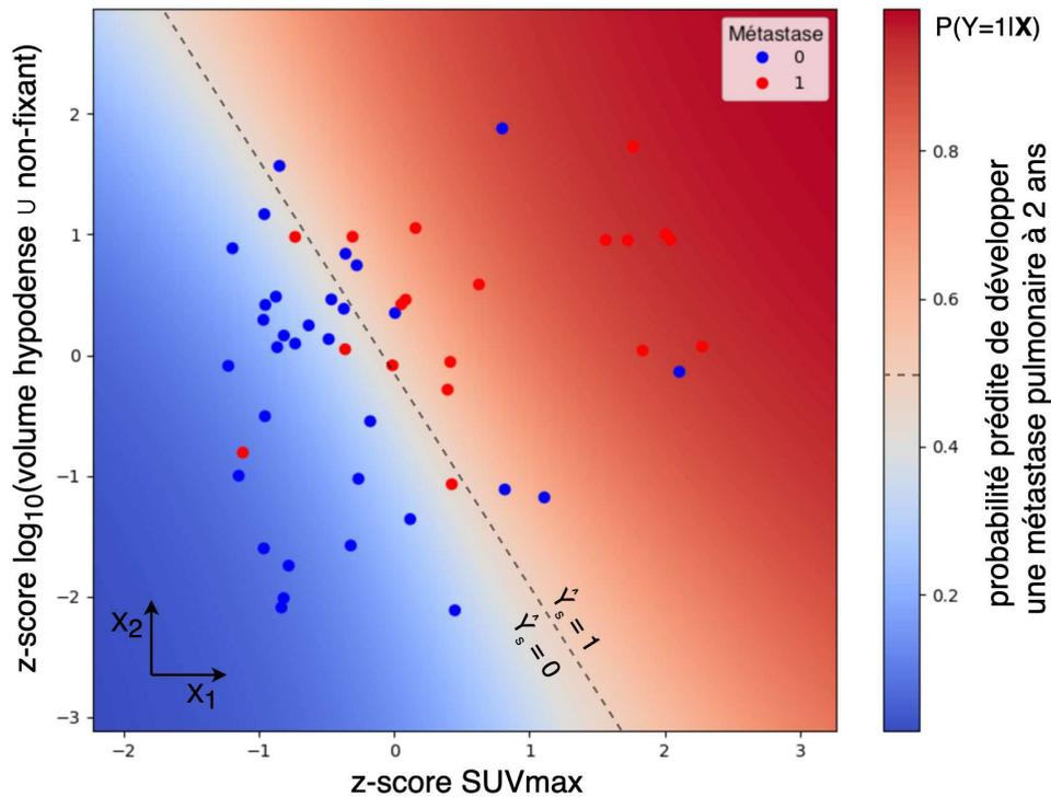
Figure 3.8 – Surface de décision d'un modèle logistique construit à partir de deux caractéristiques ( $X_1$  et  $X_2$ ) pour prédire la survenue de métastases pulmonaires dans les deux ans suivant le bilan d'extension pour des patients atteints de STS à partir d'images TEP/TDM. Un seuil de probabilité à 0,5 établit une frontière de décision permettant de classer automatiquement les patients en deux niveaux de risque. Figure adaptée d'Escobar et al. [174].
