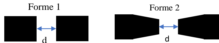
Figure IV-5 : Différente forme d'entrefer.
