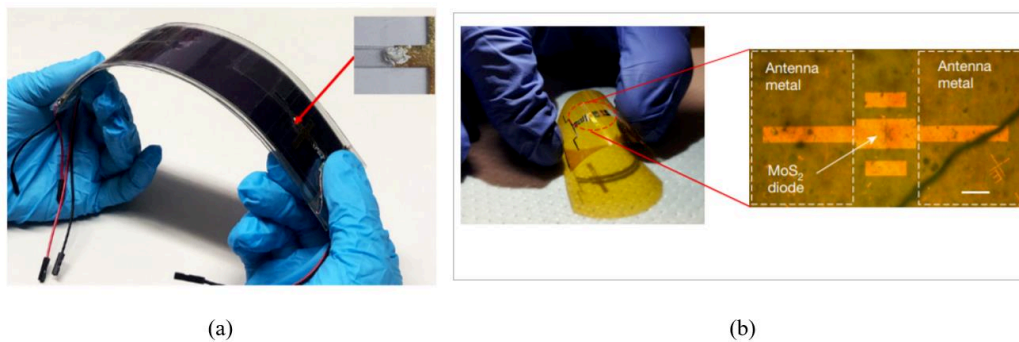
Figure I-18. Récupérateur d'énergie (a) hybride RF/solaire [101] (b) électromagnétique [102]
