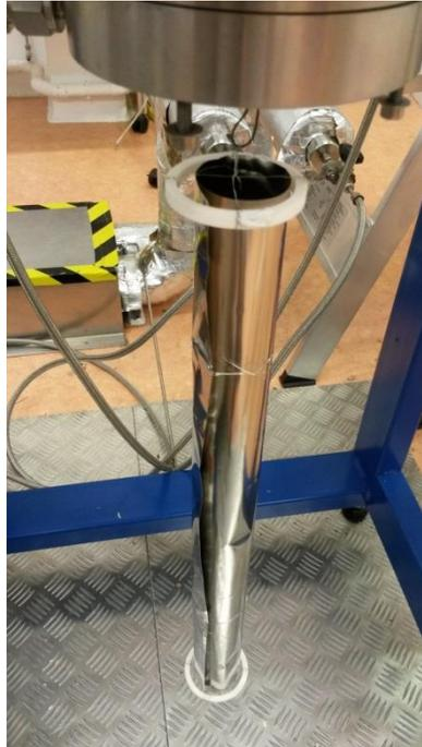
Figure 33. Feuille d'acier 316L fixée dans le porte-échantillon
