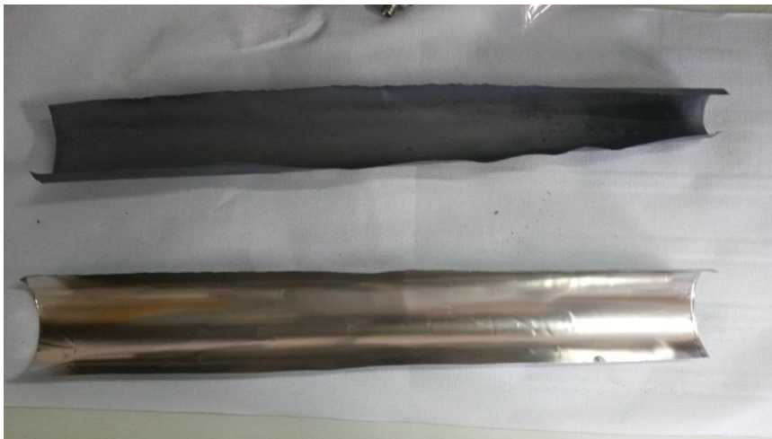
Figure 107. Feuille 316L avant pré-oxydation (en bas) et après pré-oxydation sous argon/vapeur d'eau et brosse (en haut)
