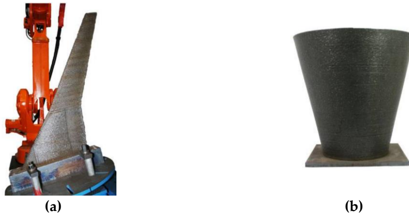
Fig. 1.9. Pièces fabriquées dans le cadre des travaux de recherche de Williams [23] : (a) modèle d'aile d'avion pour soufflerie et (b) cône profilé
