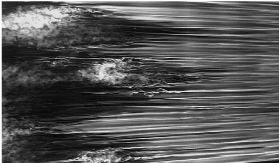
(b) Spot obtenu en écoulement de couche limite par Lundell et al. (2009)
