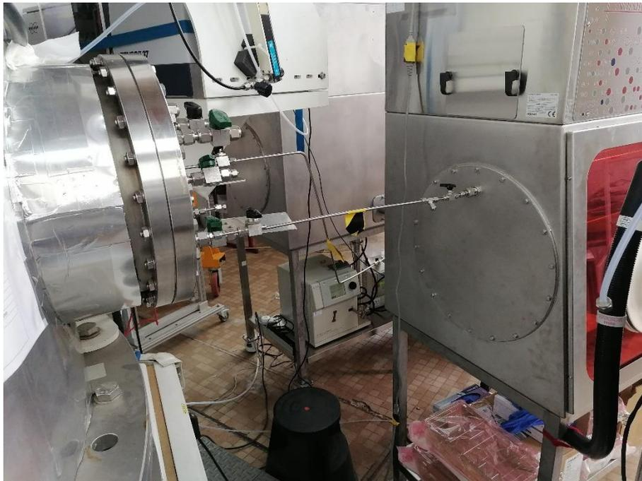
**Figure 19** Ligne de transfert de l'atmosphère entre CESAM et l'isolateur exposé.
