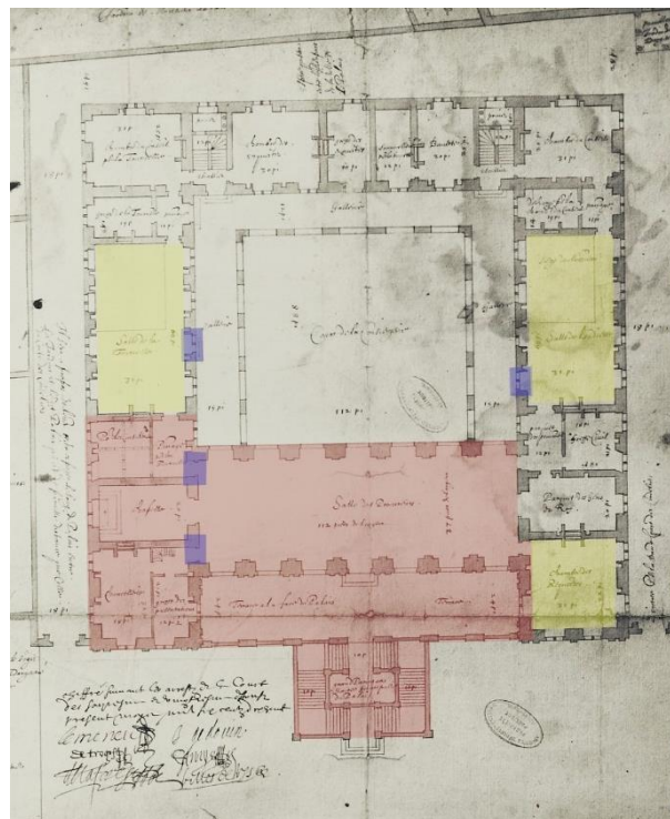
Figure 98 : Plan du premier étage du Parlement de Bretagne avec en rouge les parties construites par Pierre Corbineau entre 1646 et 1655. Les salles en jaune sont celles ayant fait l'objet de travaux de reprise par l'architecte, idem pour les portes en bleu. Musée de Bretagne, Photographie du plan du premier étage du Parlement de Bretagne réalisé par Salomon de Brosse en 1618, plan aujourd'hui détruit. M0212_AG-956-2-187-U.
