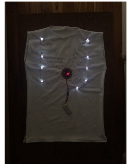
Vêtement lumineux circuit Lilypad, led, fil de cuivre
