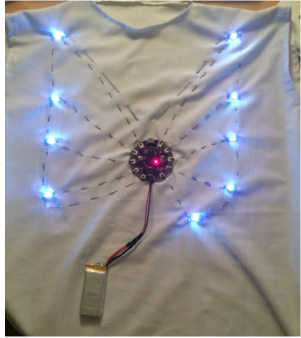
Tee-shirt lumineux Matériaux : Lilipad, LED, Batterie
