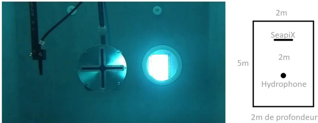
FIGURE 6.2 – Le SeapiX dans une piscine face à un hydrophone
