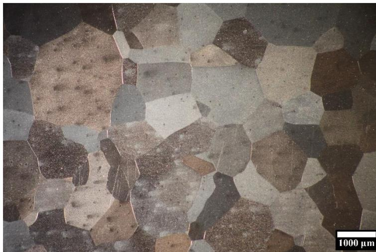
Figure III-3 Micrographie optique de la microstructure 100 %  $\beta$  après attaque chimique.
