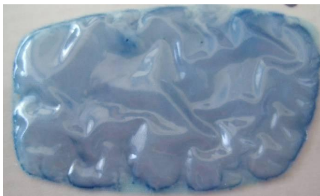
Figure 136- Photo du gonflement du Parylène-C encapsulant du E7 + 1% de colorant savinyl bleu
